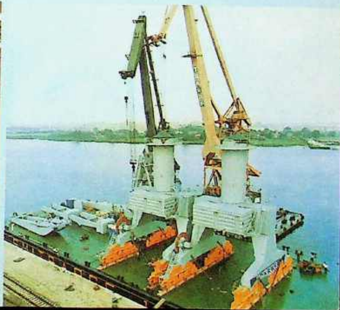
Schwimmkräne aus dem VEB Kranbau Eberswalde werden per Schiffsponton nach Rotterdam transportiert
